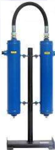
Фильтрационный модуль предназначен для тонкой очистки сжатого воздуха и различных газов от аэрозолей масла и влаги, а также от твердых частиц размером более 3 мкм. Обеспечиваемое остаточное содержание аэрозоля масла - менее 5 мг/м<sup>3</sup>. Используется в системах пневмоуправления и автоматики, пневмоприводе устройств и инструмента для окраски поверхностей распылением.
