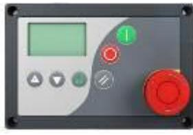
Программируемый многофункциональный контроллер **СМС Airmaster P1 и S1** производится в Бельгии. Контроллер Airmaster отображает текущую информацию о состоянии компрессора, о его нагрузке/ходостом ходу, времени отключения, аварийных режимах, времени наработки, обеспечивает доступ к настройкам компрессора, а также о предстоящих ТО. Контроллер Airmaster защищает компрессор и производит его остановку при аварийных ситуациях. Есть возможность дистанционно управлять компрессором.
